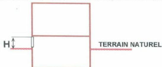
Ouverture placée à plus de 1,90 m du plancher, H supérieur ou égal 1,90 m
