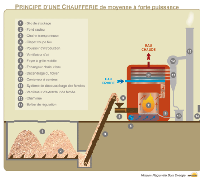
FIGURE 20 PRINCIPE D'UNE CHAUFFERIE BOIS
